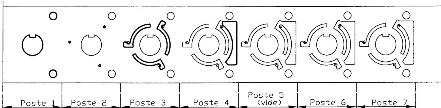
Poste 1 : Poinçonnage de l'évidement central + Poinçonnage des 2 trous de pilotage
