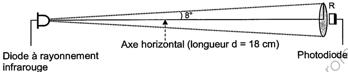
**B.1 Validation du positionnement de la photodiode.**
