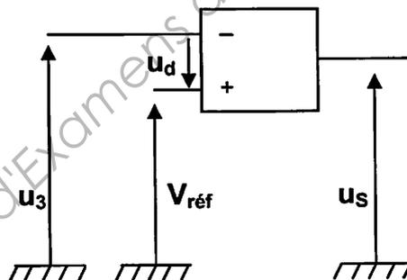
Lorsque la tension de sortie  $u_s$  sera égale à 9 V, une alarme sonore se déclencherà. Dans le cas contraire, elle restera muette.
