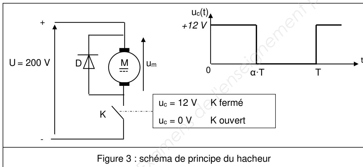
**Q12.** Préciser le rôle de la diode  $D$ .
