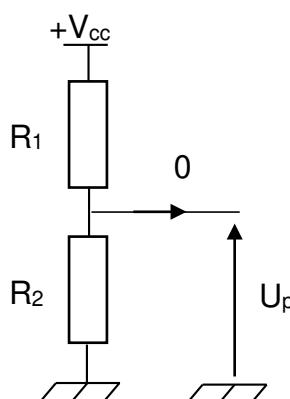
*Lorsque le tapis est en position basse alors :  $R_1 = 8,8 \text{ k}\Omega$ ,  $R_2 = 1,2 \text{ k}\Omega$  et  $U_p = 0,6 \text{ V}$ .*
