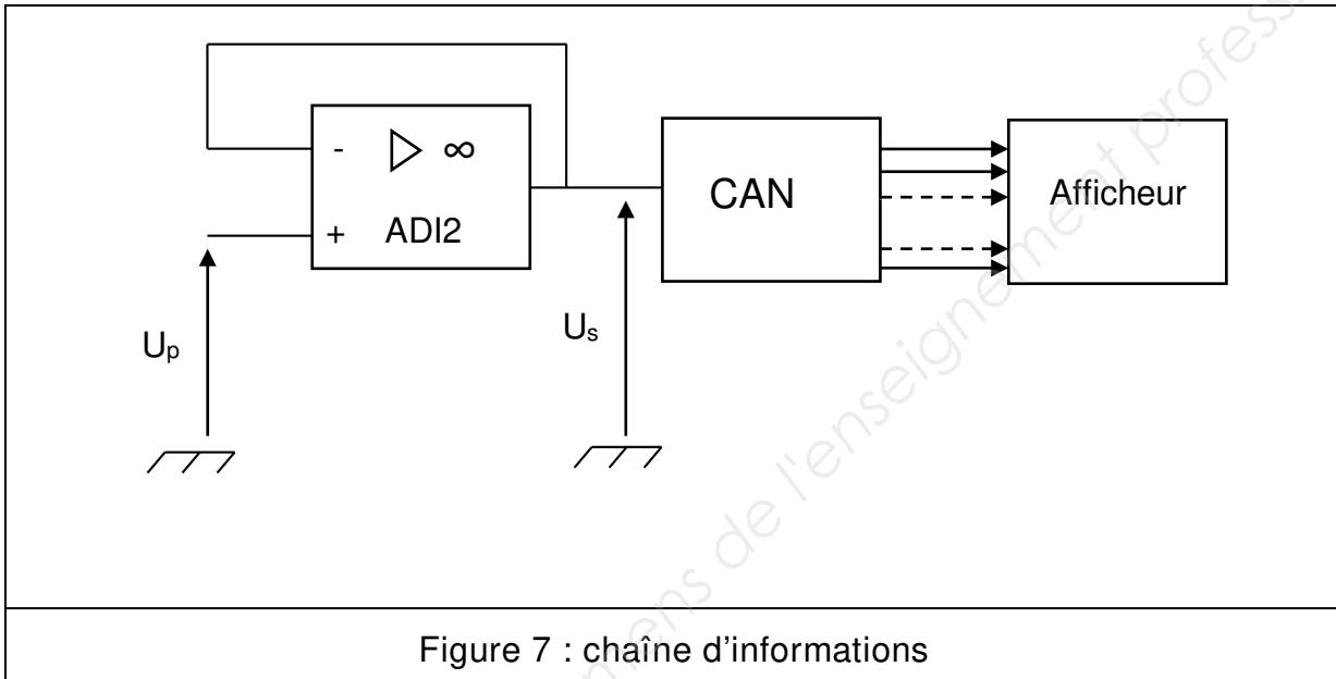
L'amplificateur différentiel intégré ADI2 est considéré comme parfait. Il est alimenté sous deux tensions + 12 V et - 12 V. La conversion s'effectue sur 8 bits.
